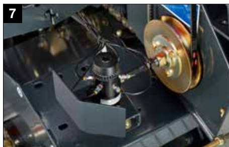
Sistema continuo de lubricación de cadenas BEKA-MAX
