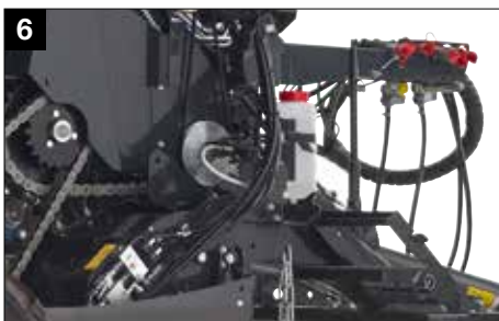
6 Sistema continuo de lubricación de cadenas BEKA-MAX
