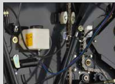
Sistema de lubricación de cadenas automático
