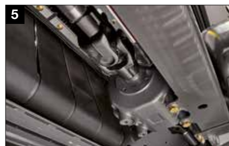
5 Juntas tipo cruceta cardán de alta resistencia en los ejes motores
