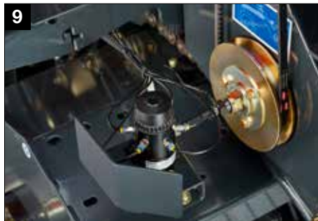
Sistema continuo de lubricación de cadenas BEKA-MAX
