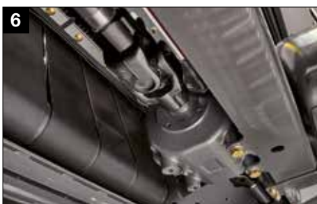
Juntas tipo cruceta cardán de alta resistencia en los ejes motores
