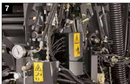
Válvula proporcional para control de densidad desde la cabina
