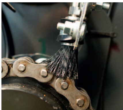
Lubricación automática de cadenas con regulación de flujo independiente para cada punto.
