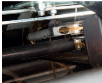
Sistema de doble atador de rápida operación.
