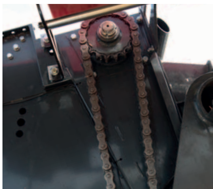
Cadena principal de accionamiento reforzada de 1 1/4". Larga vida útil y mínimo mantenimiento.
