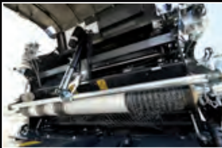
Atador de hilo independiente del atador de malla.
