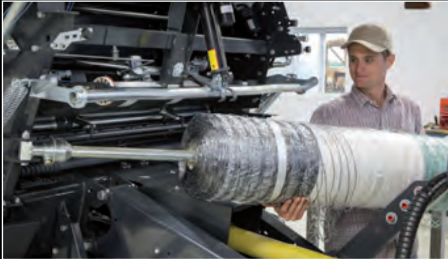
La baja altura y fácil carga de las bobinas minimiza las pérdidas de tiempo en la sustitución de las mismas.
