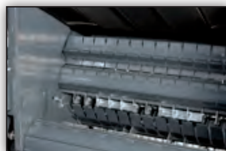
Los rodillos frontales con rascadores de limpieza, permiten trabajar en silo con una formación instantánea de la paca.
