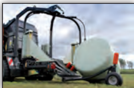
Volteador de pacas. En transporte queda en posición segura, dentro de la unidad de encintado.
