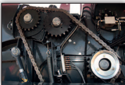
Una cadena de 1¼" de larga vida útil y mínimo mantenimiento es la encargada de transmitir el esfuerzo a los principales accionamientos de la rotoempacadora.
