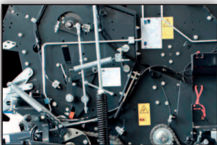
Tuberías hidráulicas metálicas.
