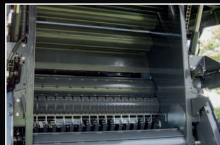
Cámara PowerMax: 17 rodillos reforzados para máxima productividad.
