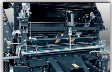
Sistema de doble atador de rápida operación.
